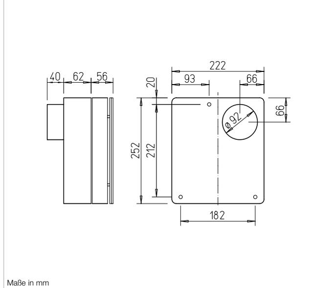
Ansprechendes Design und die verdeckte Ansaugöffnung kennzeichnen die Universal-Baureihe DX. Das Gerät ist leistungsstark, einfach zu installieren und eignet sich für die Entlüftung kleinerer Räume im privaten, gewerblichen und industriellen Bereich.
