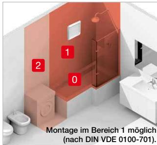
Montage im Bereich 1 möglich (nach DIN VDE 0100-701).
